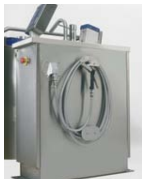
Slangeoprul og udtag på siden af søjlen
