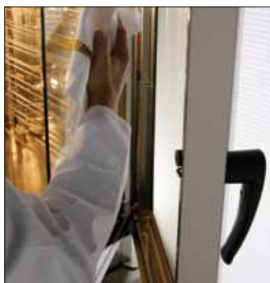
Dobbelt termo-glas i døren med drypbakke for at lette rengøring.
