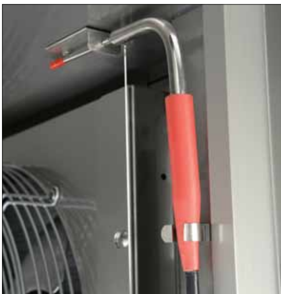
Kernetemperaturføler med 3 målepunkter
